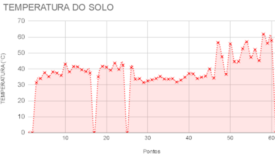
Figura 2: Gráfico de temperatura nos pontos de monitoramento situados na trilha.
