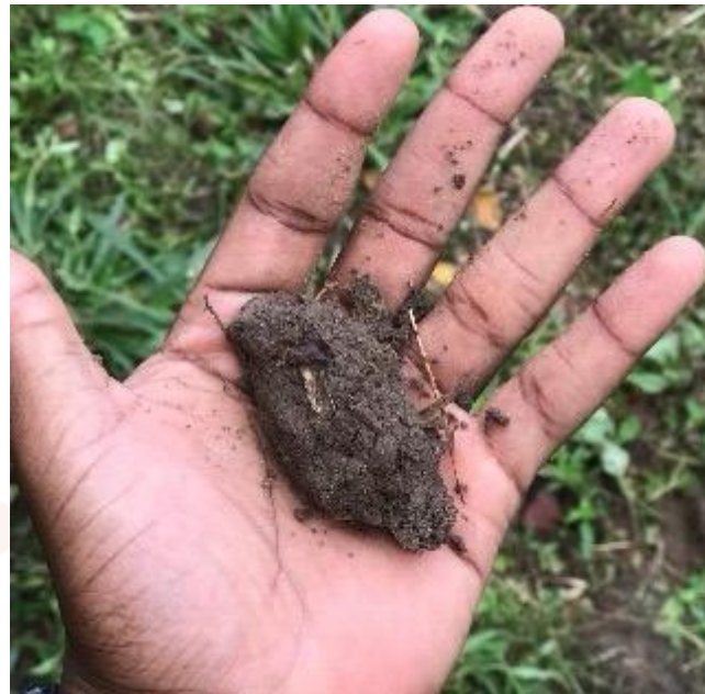
Figura 1 : Método de determinação de textura de solo por tato
