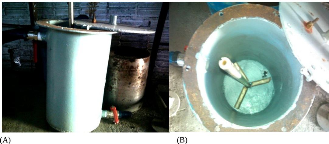
FIGURA 1. Vista lateral (A) e Vista superior (B) do Biodigestor finalizado, construído para utilização como fonte de criação e gerenciamento do gás produzido pelo mesmo e pelo TEvap.
